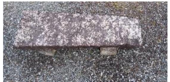
④トンネルに使用された三河産の花崗岩の石材の一部(長さ約1m)
